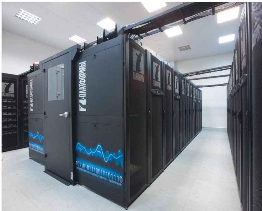
Ряд стоек T-Blade 1 установки “Чебышев” производительностью 60 ТФлопс в МГУ
