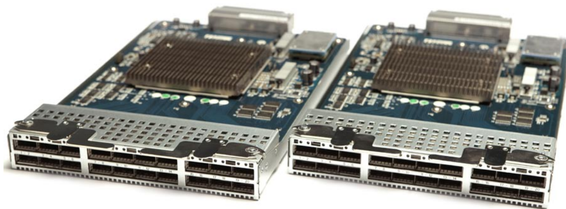
Рисунок 6. Модули QDR InfiniBand
